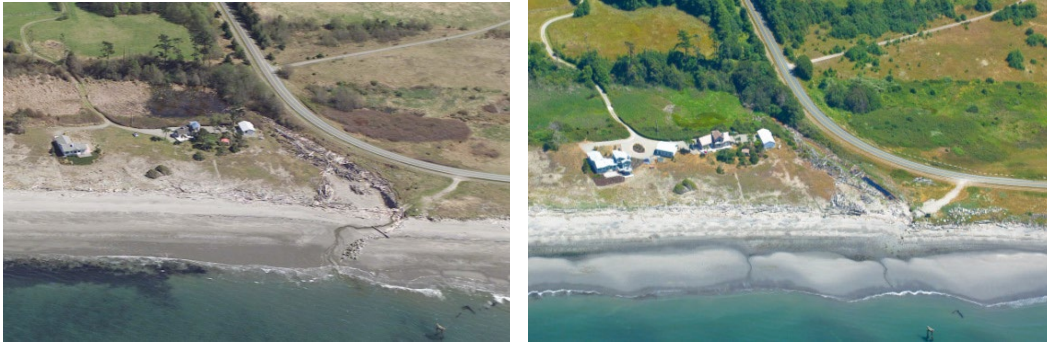
Figure 1.4.2. Retrait de l'épi sur l'île Whidbey, WA : avant et après. Bien que le retrait n'ait pas été achevé, l'érosion sur la partie gauche ou en aval a diminué en raison de l'interruption réduite de la dérive littorale ; notez que le rivage sur la gauche de l'épi est moins en retrait ou en décalage après le retrait. Crédit : J. Johannessen.
